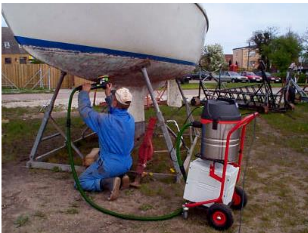
Figur 17: Pussing av skrog med pussemaskin tilkoblet støvsuger. (Foto: Miljøstyrelsen)
